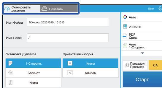
Для сканирования оригиналов и отправки сканированных данных коснитесь вкладки [Сканировать документ].
