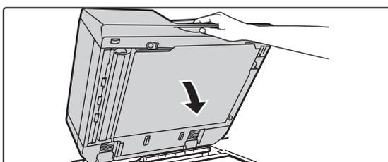
**Проследите за тем, чтобы прижимная поверхность оригиналов была надежно прикреплена к автоматическому подающему лотку документов, затем закройте автоматический подающий лоток документов.**
