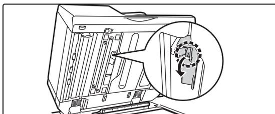
Возьмитесь за фиксатор на блоке штамповки и выньте блок.
