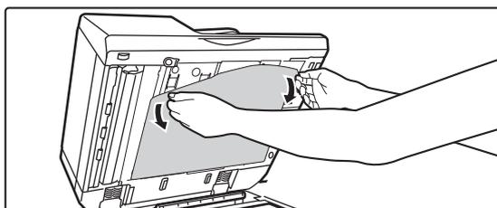
Выньте из автоматического подающего лотка документа прижимную поверхность оригиналов.
