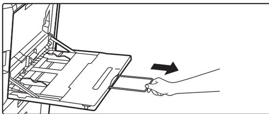
Выдвиньте направляющую при загрузке бумаги, формат которой превышает 8-1/2 x 11"R или A4R. Полностью выдвиньте направляющую.
