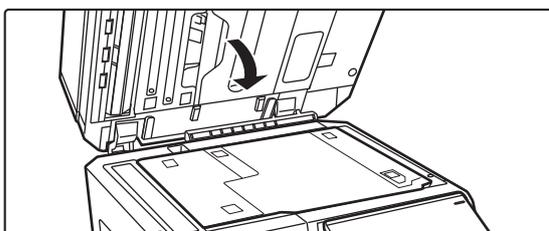
**Закройте автоматический подающий лоток документа, чтобы присоединить прижимную поверхность оригиналов.**
